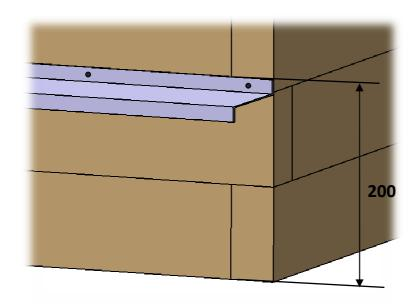
Die Schneckenschutzleisten werden, gemessen von der Unterkante des Hochbeetes, etwa in einer Höhe von 200 mm befestigt. Dazu werden selbstschneidende Schrauben verwendet die ohne Vorbohren durch die Leisten ins Holz geschraubt werden können.
